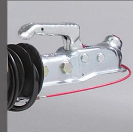
Kugelkopfkupplung für höhenverstellbare Zugdeichsel
